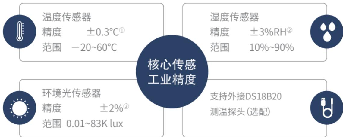
① 0-65°C范围内,温度测量精度为 $\pm 0.3$ ;② 25°C室温情况下,10%-90%RH湿度范围内精度为 $\pm 3\%\text{RH}$ ,其余为 $\pm 4\%\text{RH}$ ;③ 照度 $>40\text{ lux}$ ,光照测量精度为 $\pm 2\%$ ;实际使用过程中,测量精度会受环境条件、设备摆放方式等因素影响。
